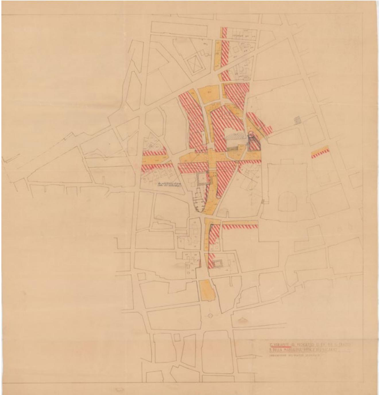
Fig. 27 - Roma, "Variante al progetto di P.R. per il tratto Piazza della Maddalena Uffici del Vicario" (in grigio ipotesi di demolizione, a tratteggio il profilo dei nuovi isolati), s.a., planimetria, s.d. [1931?], 1:1.000, copia eliografica colorata a matita, 76 x 80,9 (AACAR, c. 8.3, dis.1).
