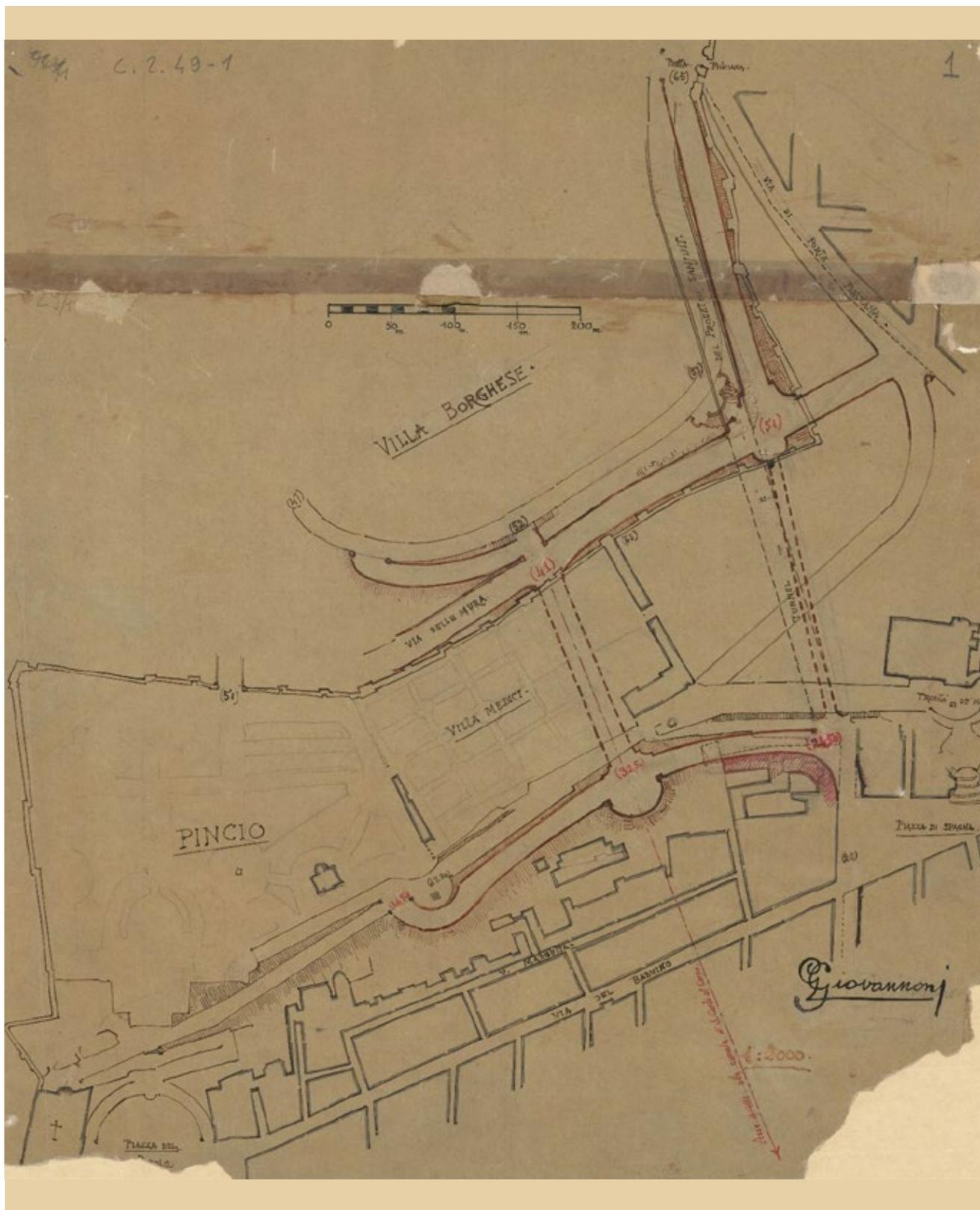
Fig. 15 - "Progetto di galleria sotto al Pincio e relativa sistemazione stradale", planimetria di studio, s.d. [ante 1913], 1:2.000, china bicolore su lucido, autografa, 44 x 45 (GG, c. 2.49, dis. 1).
