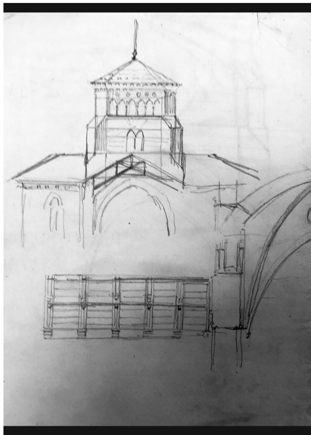
Fig. 14 - Cosenza. Cattedrale, sezione e sezione-prospetto sul transetto, matita su carta. Dal disegno emerge la volontà di far prendere luce alle bifore del tiburio medioevale e di costruire un secondo piano a formare una vera e propria torre nolare (APC, Disegni relativi a Giuseppe Pisanti e Silvio Castrucci, C3).
